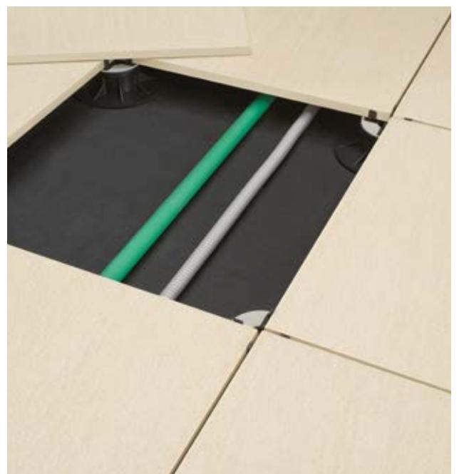
**NELLA MODALITÀ SOPRAELEVATA.** AL DI SOPRA DEL MASSETTO OPPORTUNAMENTE IMPERMEABILIZZATO, LE LASTRE AEXTRA20 VENGONO POSATE A SECCO SU APPOSITI SUPPORTI, CHE NE DETERMINANO LA DISTANZA DI CIRCA 3 MM. SI VIENE COSÌ A CREARE UN VANO TECNICO SOTTO IL PIANO DI CALPESTIO, ISPEZIONABILE SEMPLICEMENTE SOLLEVANDO LE LASTRE.
