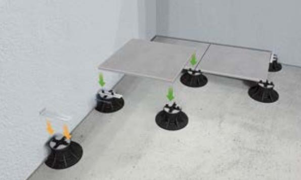
LA CLIP BORDO PIASTRA SI INCASTRA NELLA PARTE SUPERIORE DEI SUPPORTI ADIACENTI ALLE PARETI CONSENTENDO IL POSIZIONAMENTO DELLE LASTRE A UNA DISTANZA UNIFORME DAI MURI. QUESTO SISTEMA GARANTISCE UNA FUGA PERIMETRALE E AUMENTA LA STABILITÀ DELLA PAVIMENTAZIONE.
