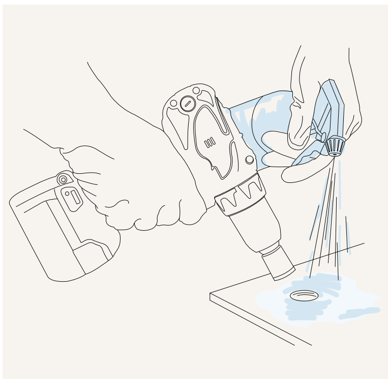
Foretto diamantato per foratura ad umido Diamond tool for wet drilling
