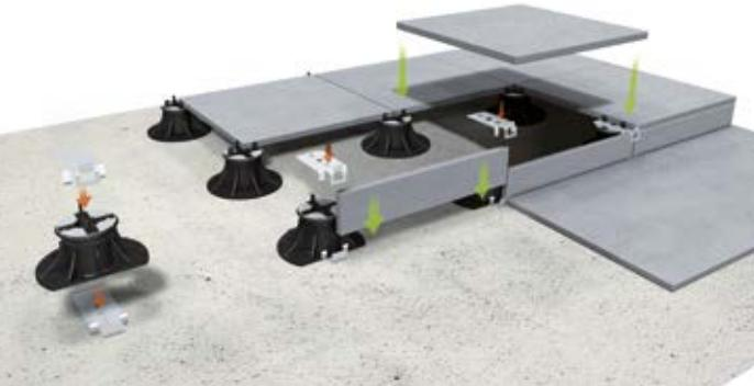
LA CLIP BORDO VERTICALE CONSENTE DI CHIUDERE LO SPAZIO PERIMETRALE CHE SI CREA IN CORRISPONDENZA DEI BORDI DEL PAVIMENTO SOPRAELEVATO NON ADIACENTI A MURI, OTTENENDO UNA PERFETTA CONTINUITÀ FRA LA SUPERFICIE VERTICALE E IL PIANO DI CAMMINAMENTO. UNA SOLUZIONE COMPOSTA DA DUE CLIP APPLICATE A INCASTRO NELLA PARTE SUPERIORE E INFERIORE DEI SUPPORTI, CHE CREANO LO SPAZIO PER INSERIRE UNA SEZIONE DI GRES TAGLIATO A MISURA.
